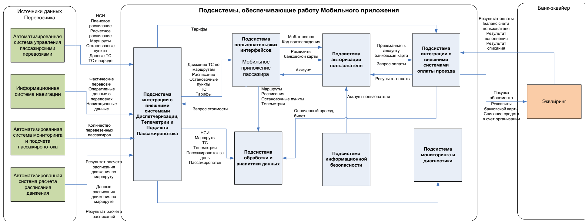
Рисунок 1 - Подсистемы прикладного серверного ПО Мобильного приложения
